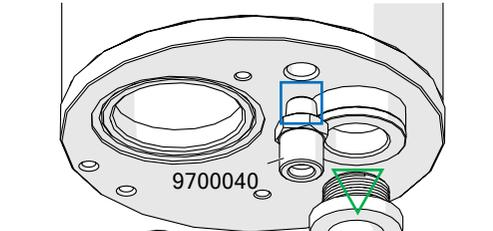
FOR SAFETY REASONS WHEN YOU CHANGE THE HEATING ELEMENT YOU MUST ALSO CHANGE THE GASKET (ASSEMBLY CODE 4000028)
